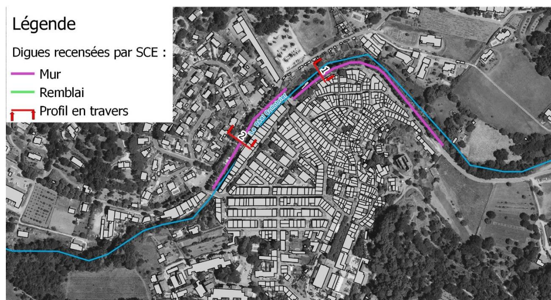
Figure 25 : Exemple de discontinuités observées sur les murs installés en crête de berge
