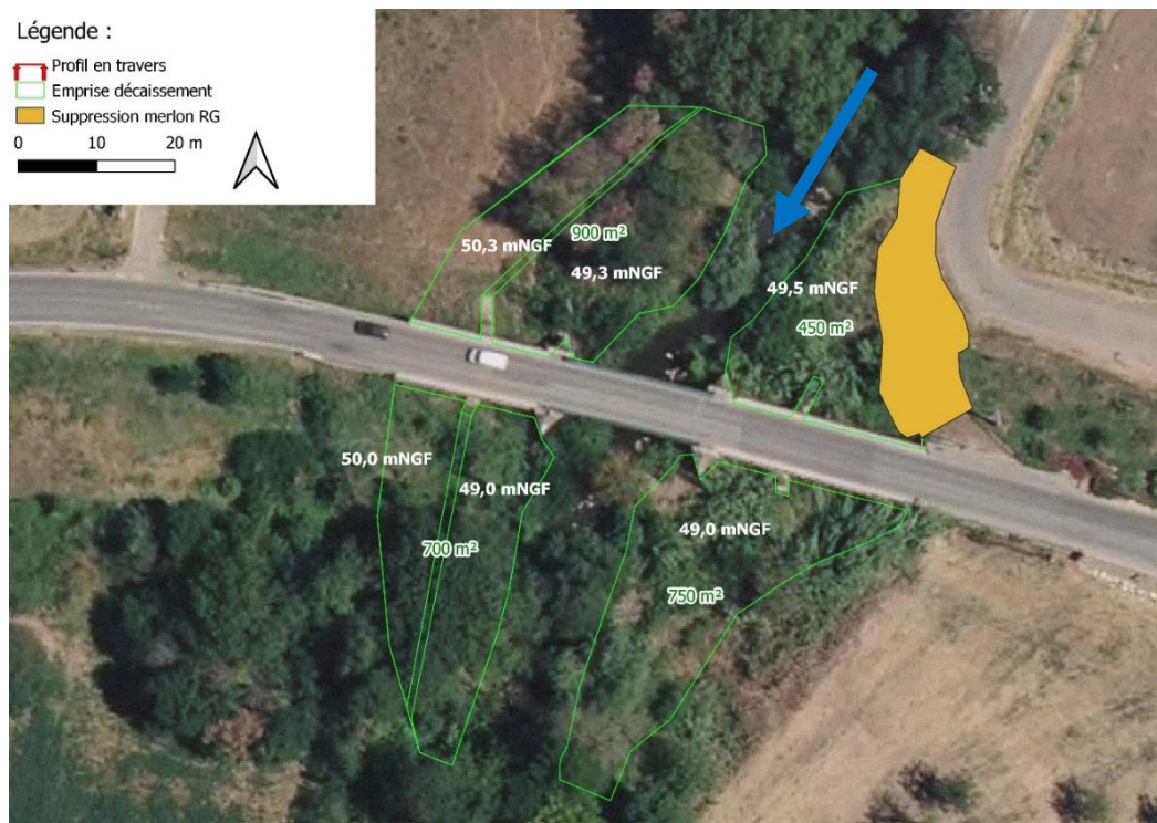
Figure 6 : Opérations de décaissement, surface (en vert) et altitude finale prévue (en blanc)
