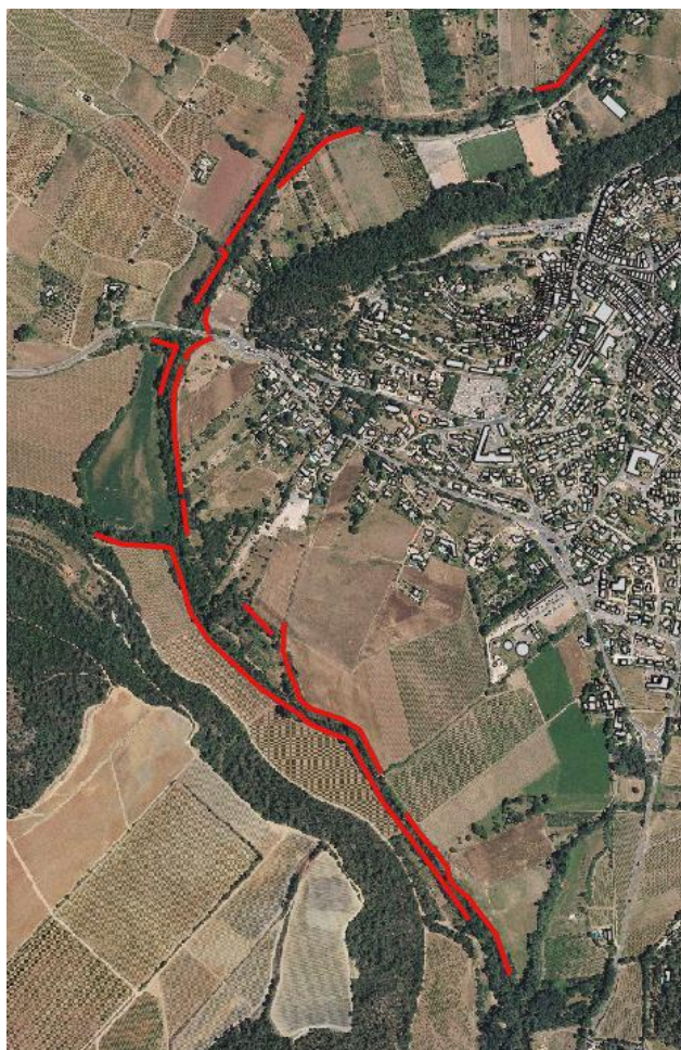
Figure 24 : Localisation des remblais (traits rouge) en lit majeur du Réal Martin à Pierrefeu-du-Var
