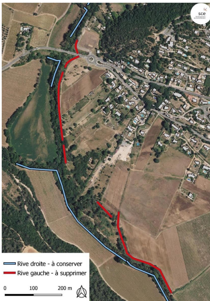
Figure 25 : Localisation des remblais à supprimer en rive gauche (rouge) et à conserver en rive droite (bleu)
