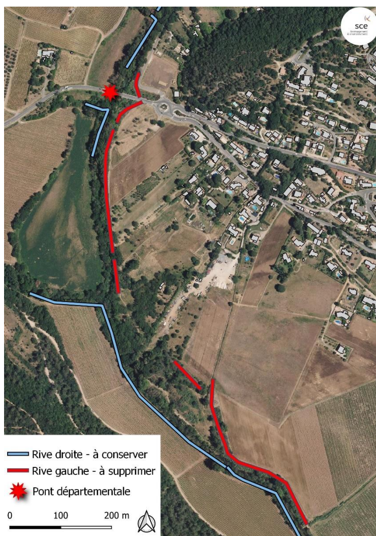
Figure 1 : Présentation des aménagements prévus - suppression des remblais en rive gauche, entretien du pont de la départementale
