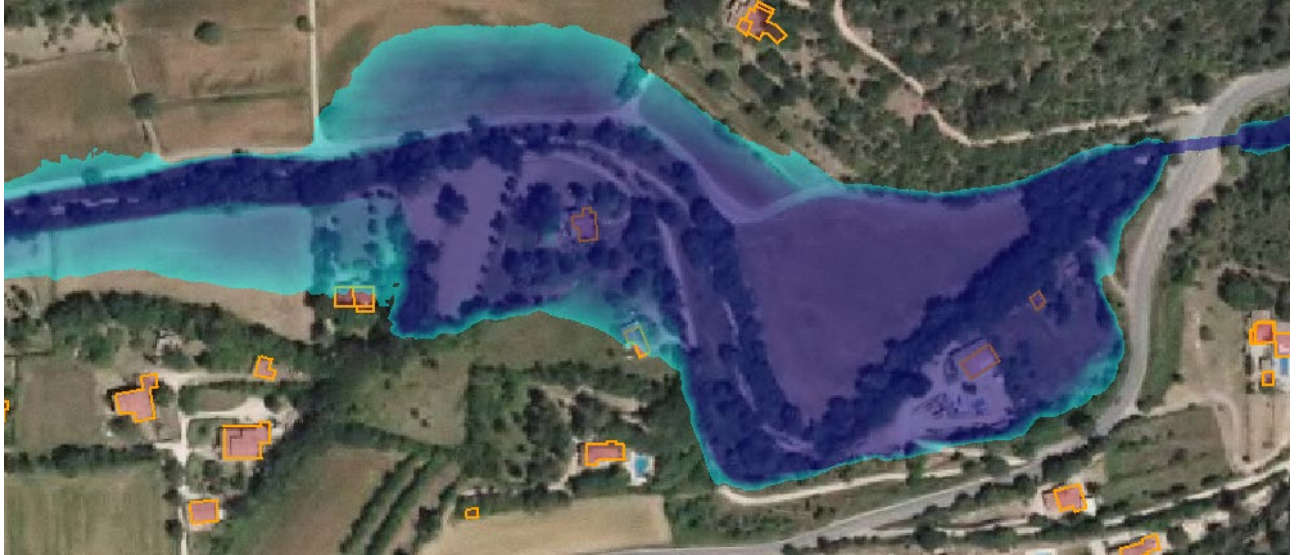
Figure 74 : Effet plan d'eau en amont du pont de la RD2 pour Q50
