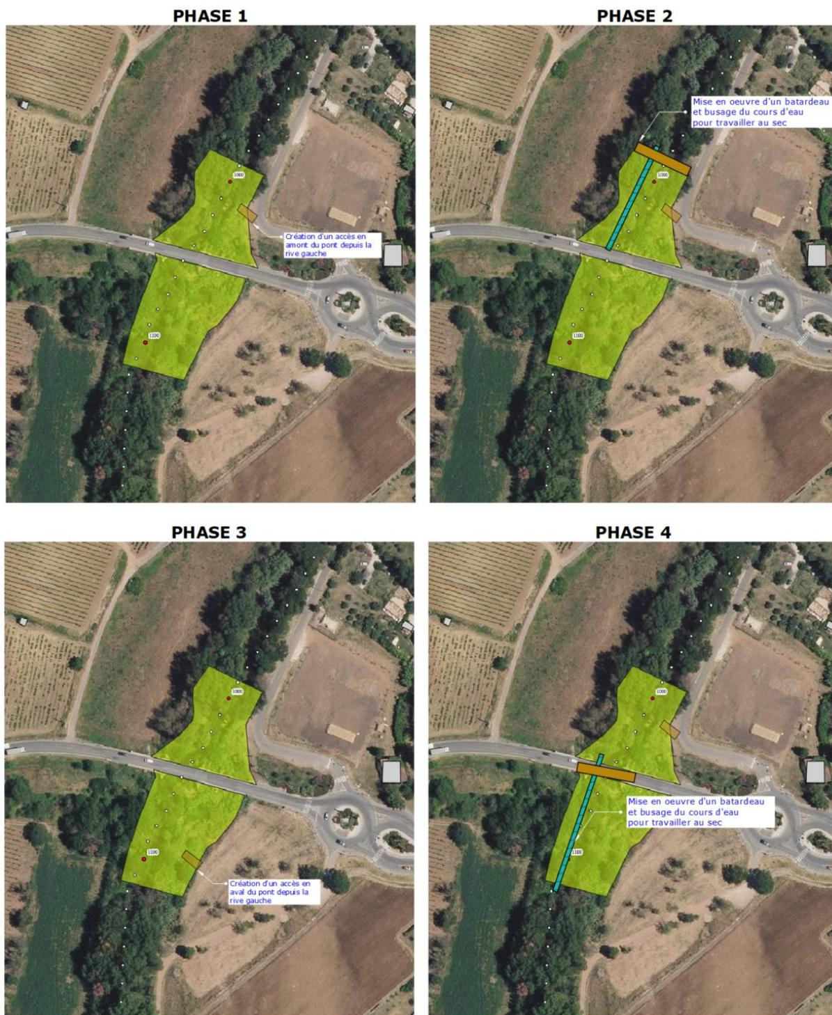
Figure 15 : Phasage pour des opérations intervenant dans le lit mineur du Réal Martin
