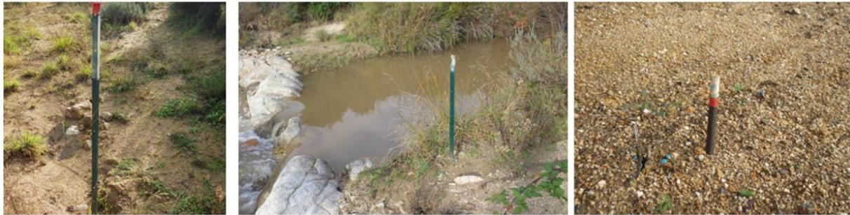
Figure 10 : Exemple de repère d'identification des profils en travers de contrôle
