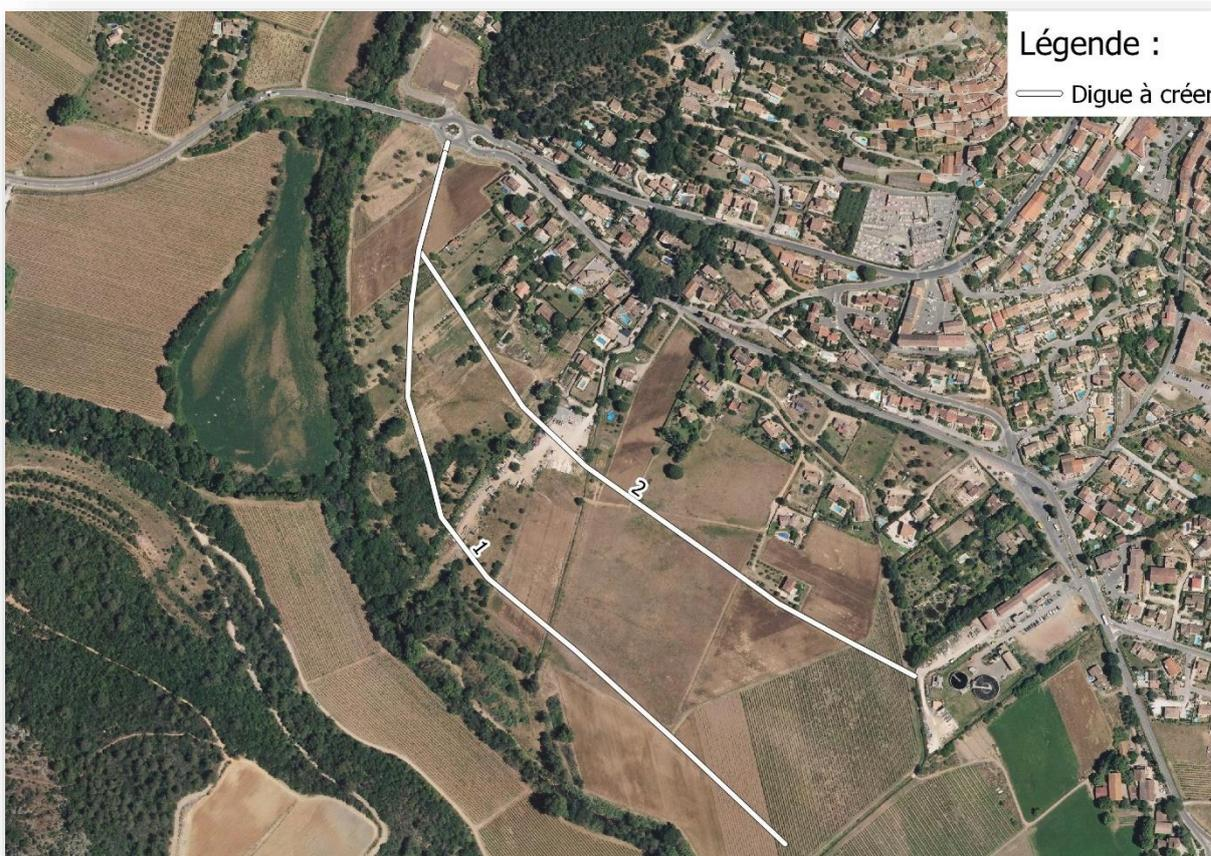
Figure 24 : Localisation des différents systèmes d'endiguement testés
