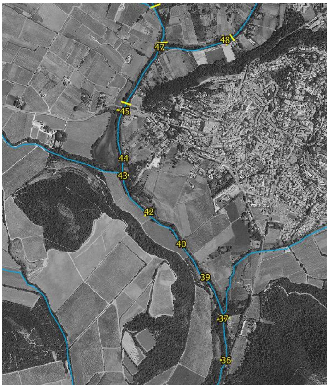
Figure 16 : Localisation des profils en travers exploités
