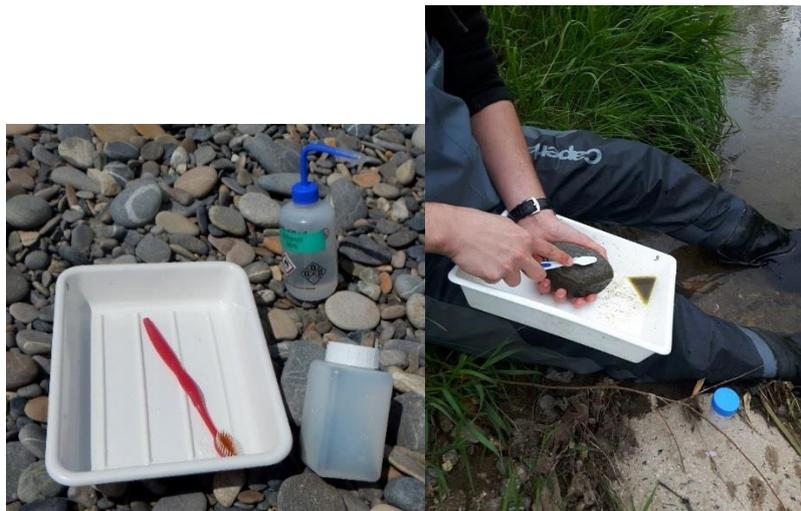
Figure 12 : matériel de prélèvement (gauche) et prélèvements des diatomées (droite)
