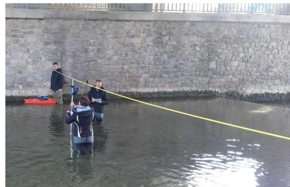
L'objectif est de connaître les débits en temps réel grâce à une relation entre la hauteur d'eau et le débit, appelée **courbe de tarage** (H/Q). Depuis 2017, les mesures du SMBVG ont permis d'établir une relation en basse et moyenne eaux. En 2019, l'étude hydraulique menée dans le cadre du PAPI a permis de modéliser les courbes de tarage des stations pour les crues.
