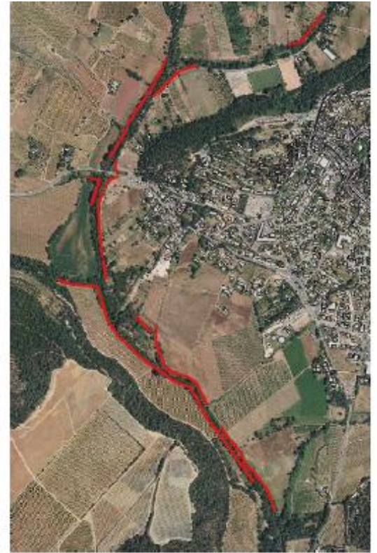
Figure 17 : Localisation des remblais en lit majeur
