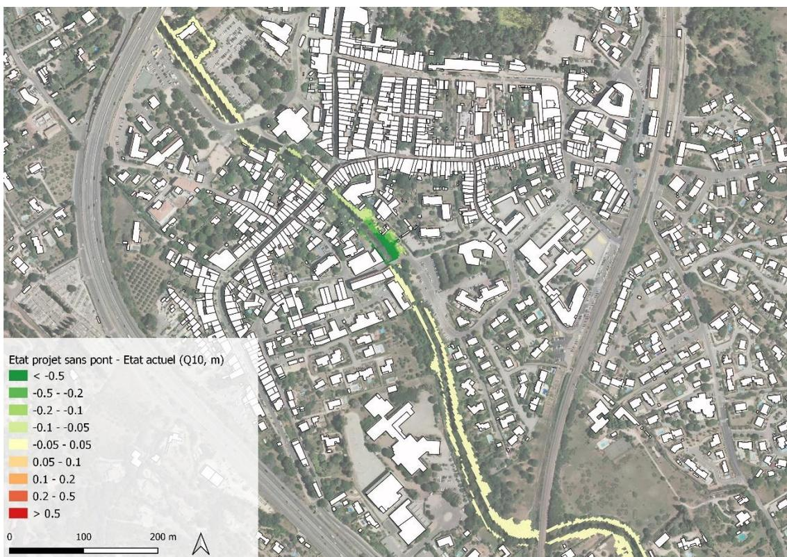
Figure 35 : Evolution des niveaux d'eau pour une crue décennale du Gapeau du fait de la suppression de l'ouvrage de la salle des fêtes
