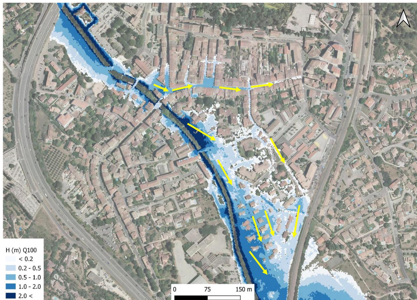
Figure 30 : Evolution des écoulements au travers d'un évènement centennal dans le centre-ville
