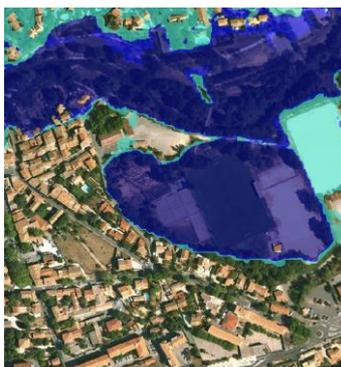
Résultats des modélisations – Hauteurs de submersion ( $H < 0,2$  m,  $H$  entre 20 et 50 cm,  $H$  entre 50 cm et 1 m,  $H$  entre 1,0 m et 2,0 m,  $H > 2$  m) – Cartographie automatique
