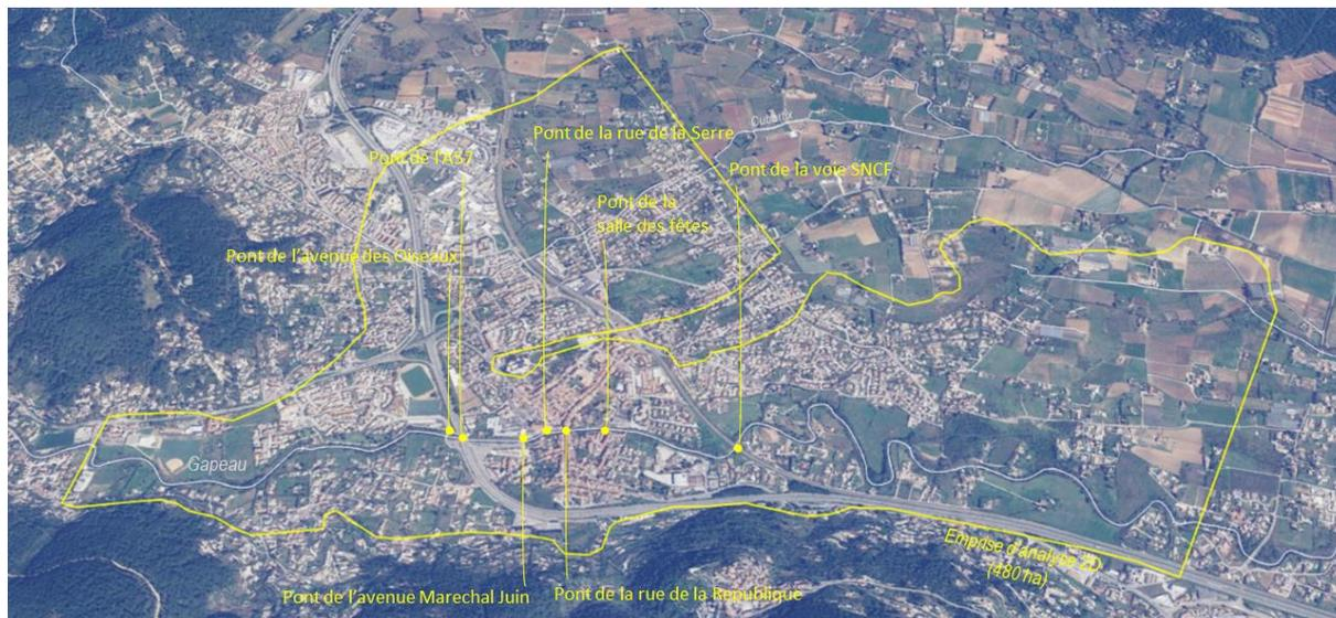
Principaux ouvrages de franchissement intéressant l'étude avec indication de l'emprise du modèle hydraulique développé.
