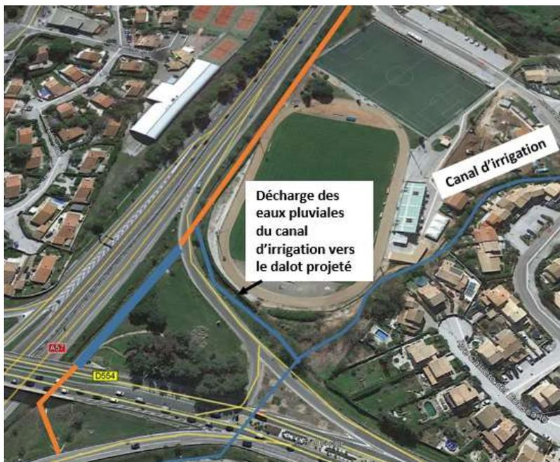
Figure 5. 29 – Décharge des eaux pluviales du canal d'irrigation vers le dalot projeté
