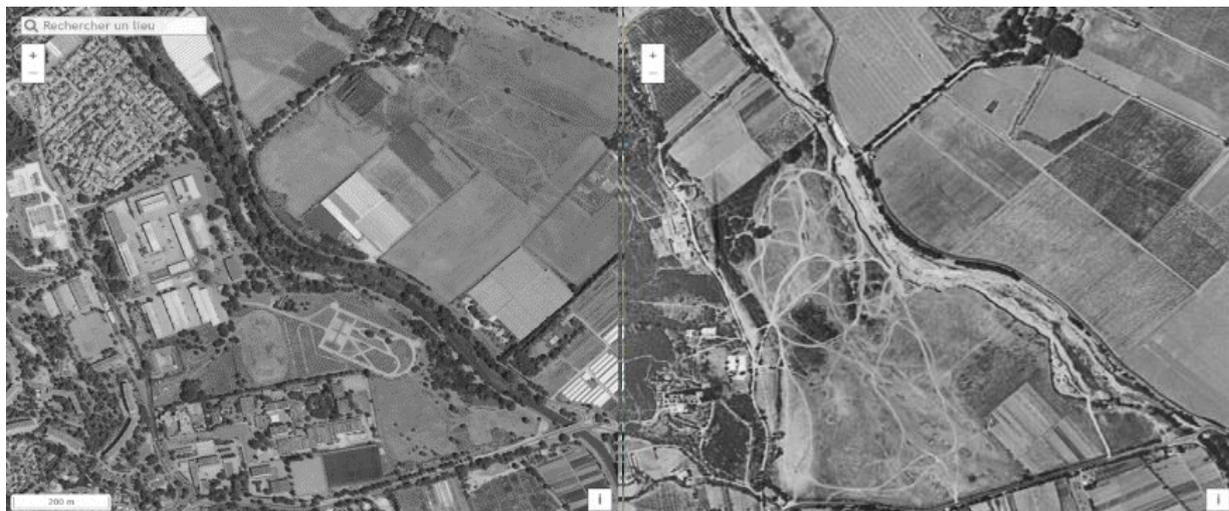
**Figure 98 - Rétraction de la bande active à hauteur du secteur 3 de Capanni : comparaison des photos aériennes du XXe s. (à droite) et de 2011 (à gauche) à hauteur du Golf Hôtel (source : IGN)**
