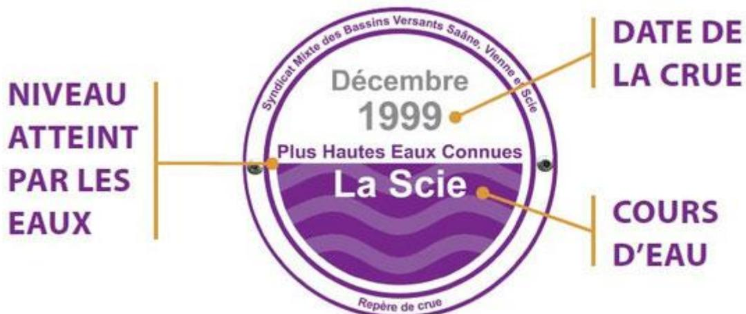
Figure 22 - Schéma d'un macaron de repère de crue (source : Syndicat des Bassins Versants Saône, Vienne et Scie)
